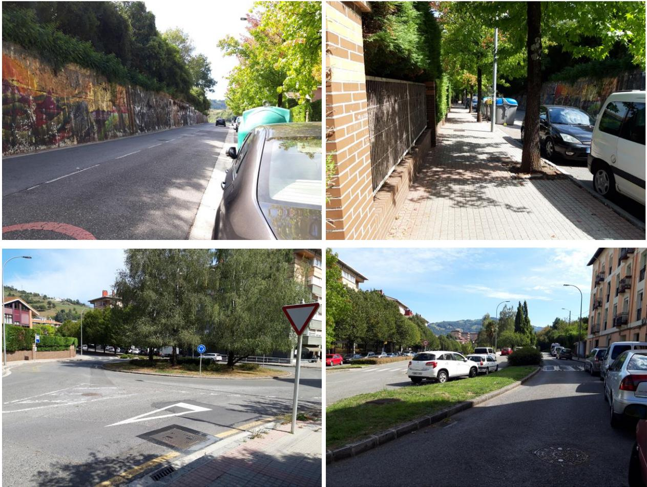
La Avda Iurramendi continua hacia el este con un único sentido de circulación. Hacia el norte de este vial vemos en el primer tramo una acera muy estrecha de hormigón, sin bordillos ni remates. Hacia el sur del vial vemos nuevamente un muro de hormigón de contención del talud.
