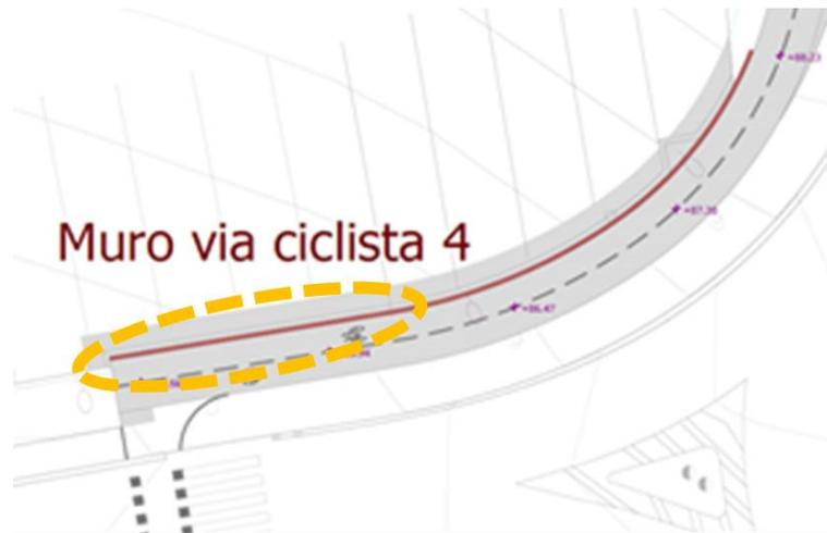
Por último, al suroeste del ámbito se genera un murete entre la nueva acera y el talud existente; este nuevo tiene una altura máxima de 5 m.
