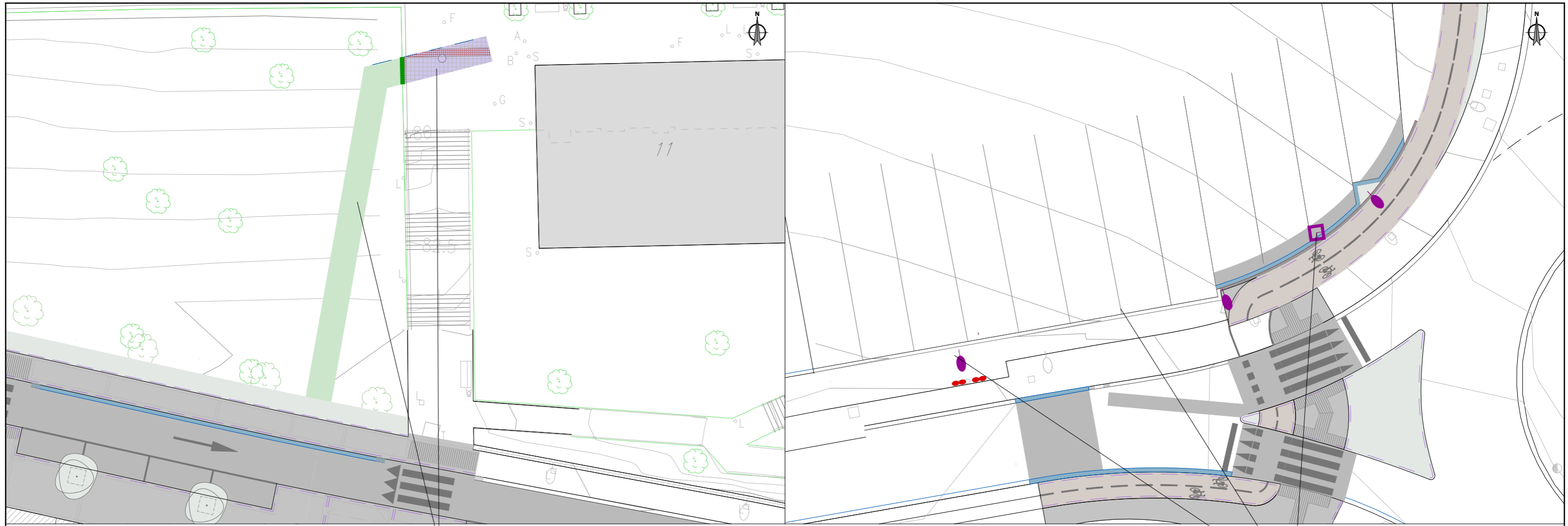
Fase 2: Reposición jardín y pavimento por nueva canalización de la red de pluviales
