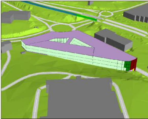
Niveles de aislamiento sin la prolongación de la pantalla acústica
