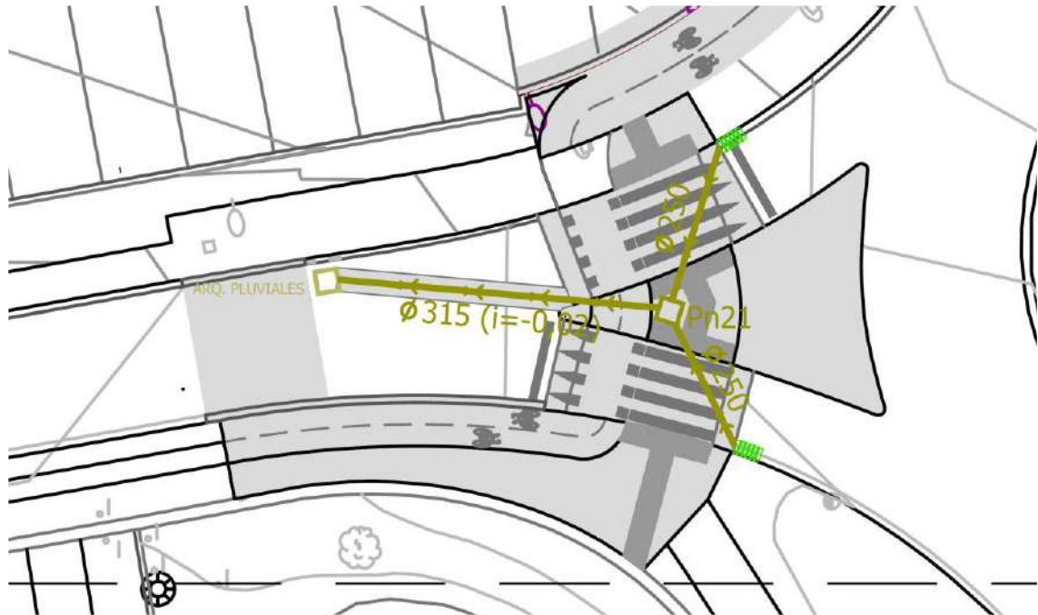
Drenaje de paso de peatones zona suroeste
