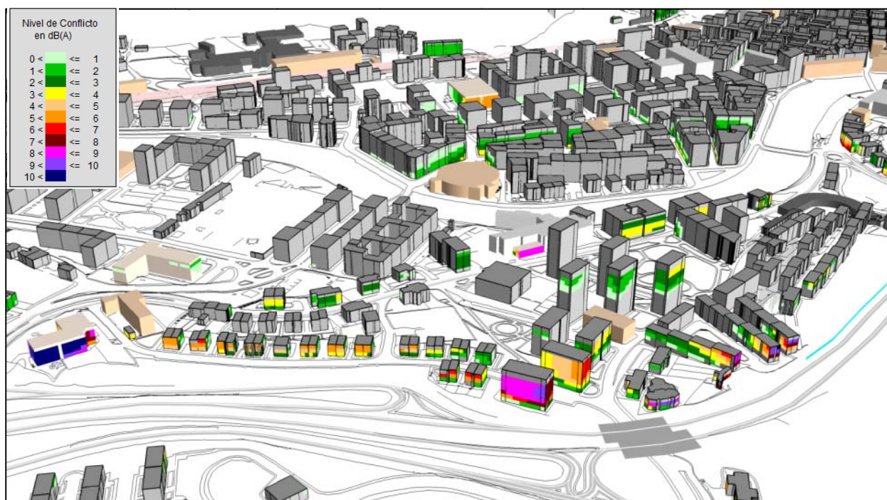
Detalle del mapa de conflicto en fachada. Ruido ambiental total. Período nocturno, L_n dB(A) Edificaciones próximas a la A-I
