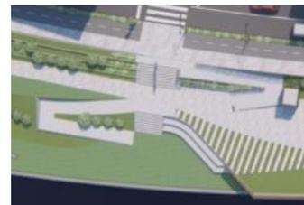
Dadas las reducidas dimensiones de la sección de calle Santa Clara, para lograr dotar a sus aceras de una anchura accesible sin quitar espacio al parque se ajusta la geometría del vial de forma que logre unas anchuras mínimas en las secciones pésimas, pero sin ensanchar innecesariamente la acera acosta de quitar espacio a la zona entre el vial y el río.
