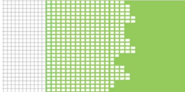
*Transición césped-losa con junta verde- losa*
